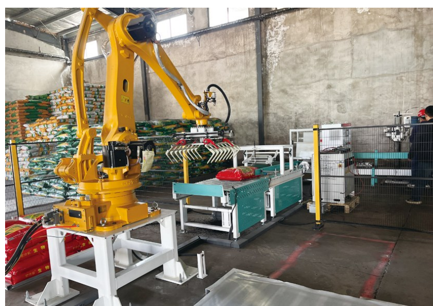
近日,和政县华丰农资经销公司的生产车间内,自动化码垛生产线有序运行。黄色的工业码垛机器人灵活作业,机械臂精准抓取袋装农资产品,完成堆码工序,为企业提质增效注入新动能。 临夏融媒记者 周俊清 摄
