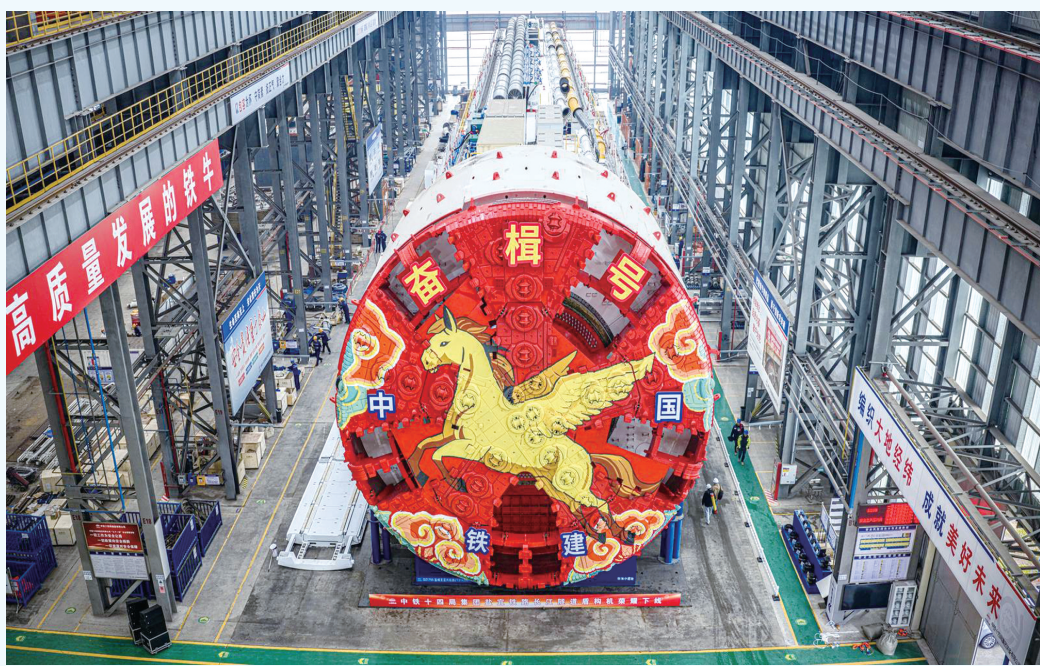
3月31日，由中国铁建打造的一台国产14米级超大直径盾构机“奋楫号”在江苏南通顺利下线，将被用于新建盐城经泰州无锡常州至宜兴高铁长江隧道工程。该工程是国内首条采用承插式管片的高铁盾构隧道，隧道的建设将推动我国超大直径水下盾构隧道向全智能建造时代迈进。 新华社发 刘甲 摄
