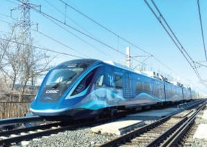
研究中心新技术研究部副部长王健介绍,中车长客在完成氢能源市域列车氢动力系统及其关键部件耐久、高低温、振动、电磁兼容、防火安全等方面试验验证的基础上,进一步开展了不同速度等级下能耗、续航里程、可靠性、牵引、制动、动力系统等整车试验,首次验证了氢能源列车在-25℃至35℃环境温度下的实际性能,试验结果中各指标均达到车辆设计要求。
