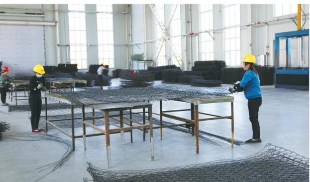
位于康乐县工业集中区的甘肃四方鑫新材料有限公司是一家复合土工材料的综合加工企业,生产石笼格宾网、各种高档针刺土工布、复合土工膜等多种土工材料。图为工人在加工石笼格宾网。 本报记者 胡沛 摄
